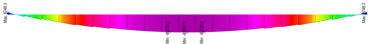
Obr. 6 Normálové napětí \sigma_c [kPa] v čase uvedení do provozu v horních vláknech průřezu od stálých zatížení
