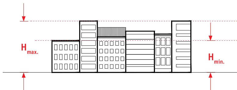
[ OBR. 28 ] Výšková hladina definuje limity maximální a minimální regulované výšky.
